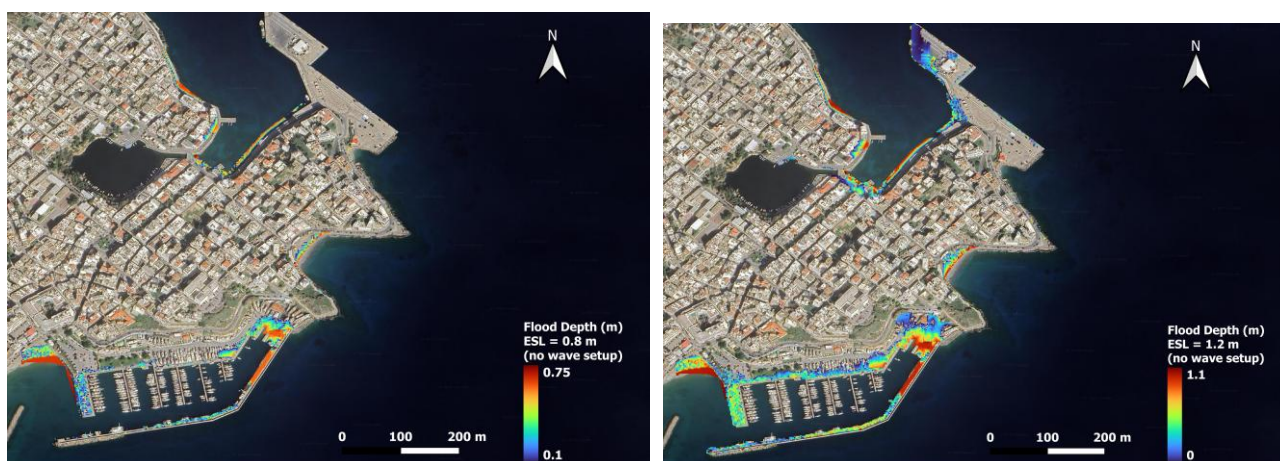
Εικόνα Π-2. Αποτελέσματα προσομοίωσης πλημμύρας χωρίς κυματική ανύψωση για τον λιμένα του Αγίου Νικολάου για το 2050 και το 2100 υπό το σενάριο RCP8.5 για θύελλα με περίοδο επαναφοράς 100 έτη.
