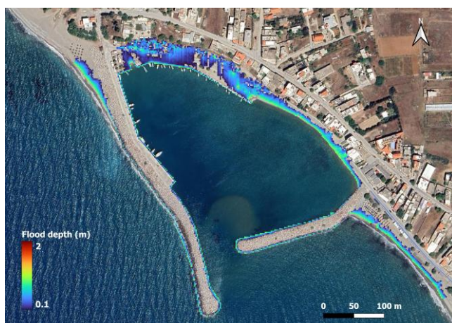
Εικόνα Π-7. Αποτελέσματα προσομοίωσης πλημμύρας χωρίς κυματική ανύψωση για το αλιευτικό καταφύγιο Κόκκινου Πύργου (Λιμενικό Ταμείο Φαιστού) για το 2050 και το 2100 υπό το σενάριο RCP8.5 για θύελλα με περίοδο επαναφοράς 100 έτη.
