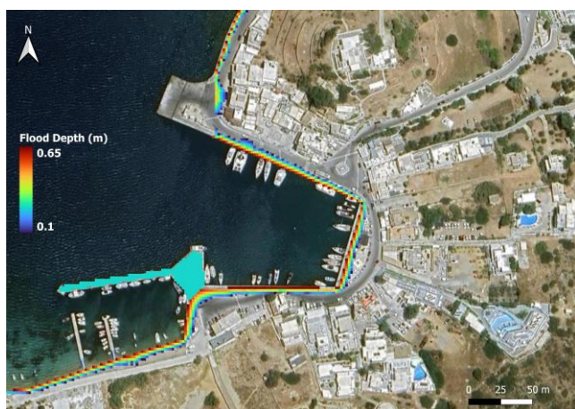
Εικόνα Π-5. Αποτελέσματα προσομοίωσης πλημμύρας χωρίς κυματική ανύψωση για τον λιμένα της Ίου για το 2050 και το 2100 υπό το σενάριο RCP8.5 για θύελλα με περίοδο επαναφοράς 100 έτη.
