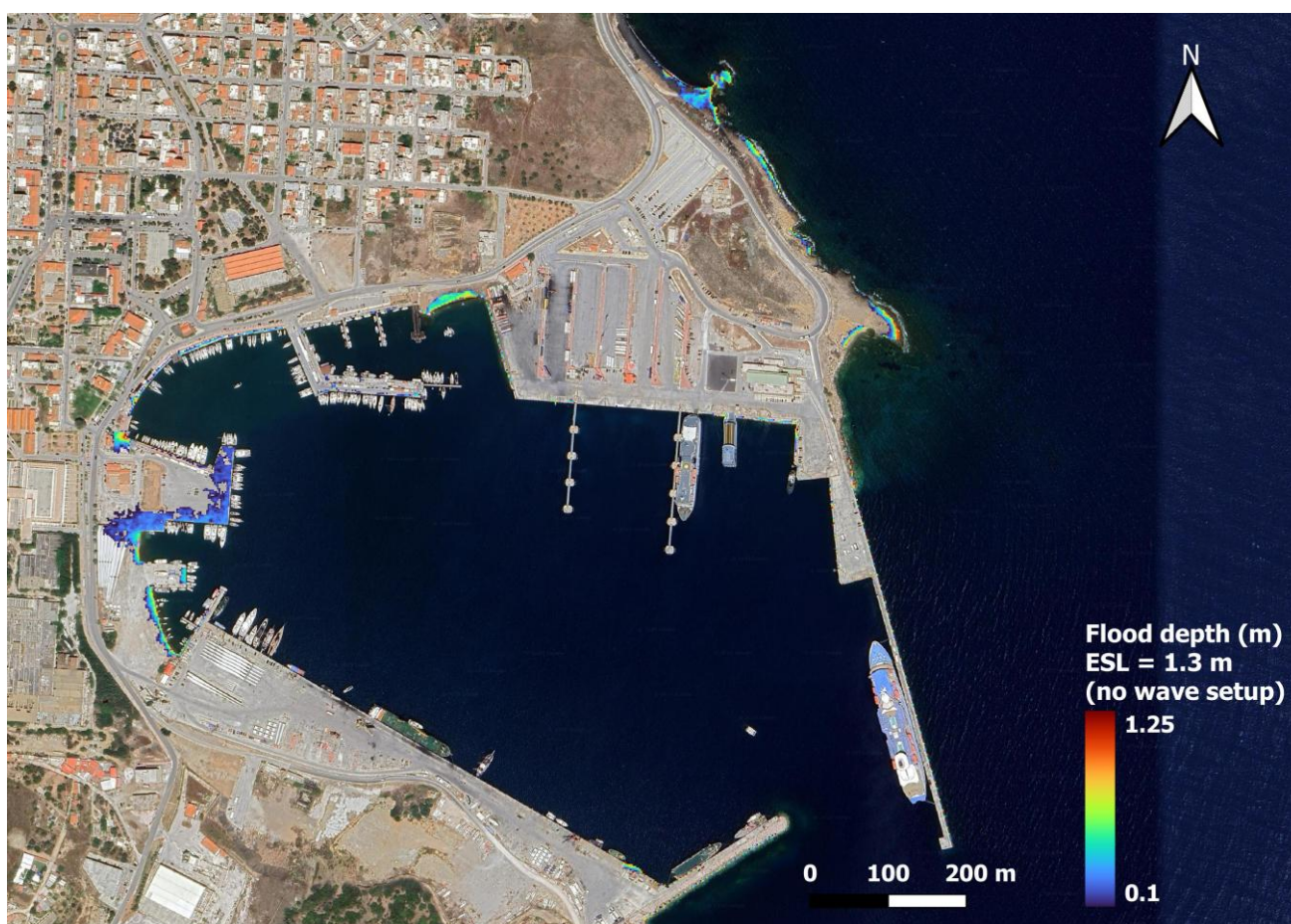
Εικόνα Π-9. Αποτελέσματα προσομοίωσης πλημμύρας χωρίς κυματική ανύψωση για τον λιμένα Λαυρίου για το 2100 υπό το σενάριο RCP8.5 για θύελλα με περίοδο επαναφοράς 100 έτη. Σημειώνεται πως πραγματοποιήθηκε προσομοίωση πλημμύρας και για το 2050 αλλά έδειξε μηδενική έκθεση στον πλημμυρικό κίνδυνο ως εκ τούτου δεν συμπεριλαμβάνεται στο παράρτημα.
